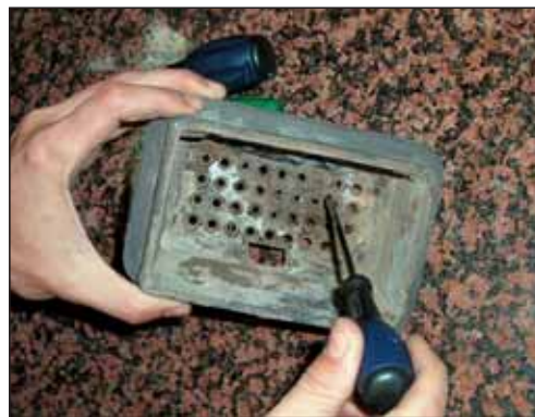
f) Pulire con un utensile eventuali fori ostruiti del braciere. Fig. 29
