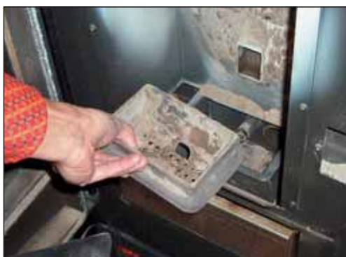
b) Togliere il braciere e aspirare la scatola sottostante Fig. 27
