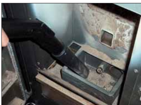
c) Aspirare il foro della candelella Fig. 28
